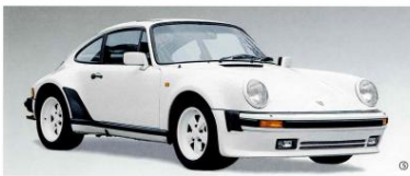
EXC 03 Bugspoiler mit geänderter Luftzufuhr für Mittelhäkchen EXC 03 Front spoiler with modified air intake ducts for center air cooler
